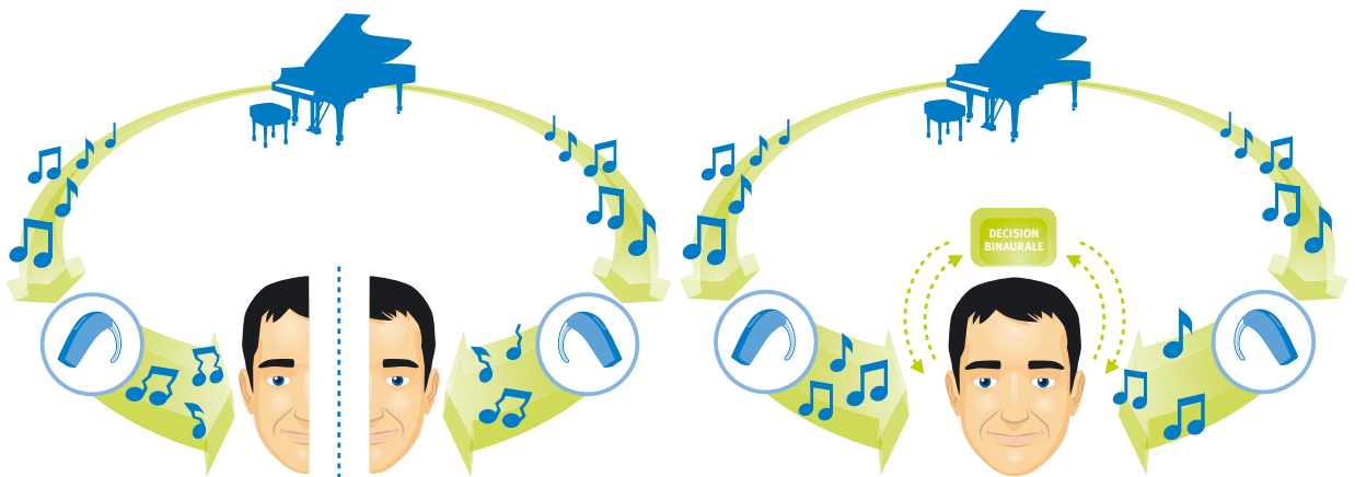
Figure 10: Comparé aux aides auditives conventionnelles opérant d'une façon indépendante, DFC compare l'effet Larsen potentiel des deux oreilles en même temps avant de déclencher une phase d'annulation.
